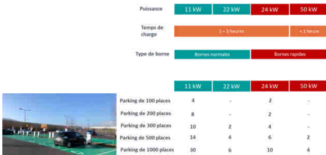
Figure 56 : Les bornes à déployer en parking de grandes-surfaces selon la taille du parking
