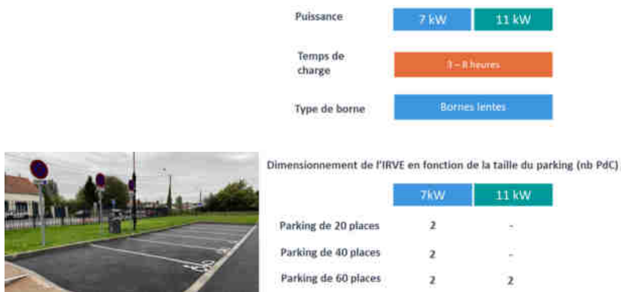
Figure 57 : Les bornes à déployer en parking de covoiturage ou P+R selon la taille du parking
